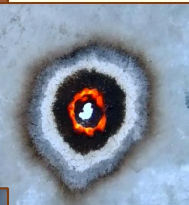
**Вывод:** оба образца показали высокую сопротивляемость воздействию огнем (для сравнения: прожиг стали, толщиной 10 мм происходит менее чем за 10 сек.). **АЦЛ** абсолютно не горючий материал, не поддерживающий горение, **ЦСП** – слабо горючий материал. При воздействии высокой температуры, материал **ЦСП** разрушился сильнее, чем материал **АЦЛ**.
