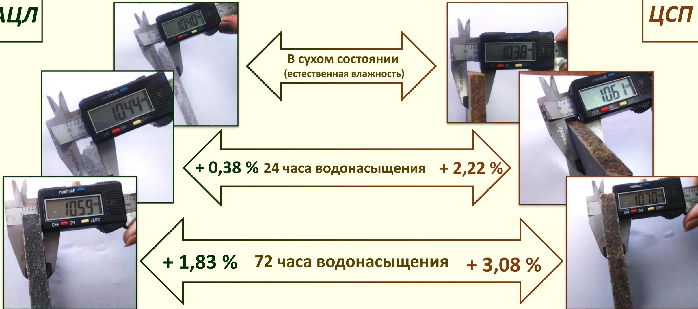
**Вывод:** изменение геометрических параметров при водонасыщении (разбухании) у АЦЛ происходит в меньшей степени, чем у ЦСП. Такое воздействие влаги совместно с перепадами температур (заморозка/разморозка) с каждым новым циклом постепенно разрушает материал и снижает его прочность. Лист АЦЛ более стоек к таким воздействиям, чем лист ЦСП.
